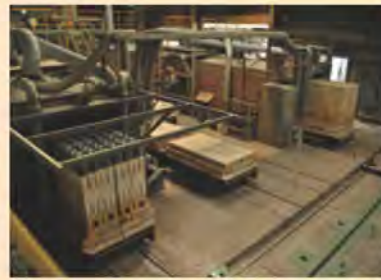
◎レンガを焼成する窯で使用される熱源は、重油からLNGに転換しCO 2 を削減。排熱はレンガの乾燥に活用しています。
